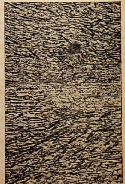
Microfoto's van Ferroxdure met gerichte kristallen. In A kijkt men boven op de zeshoekige basisvlakken van de kristallen; in B zijn de kristallen gekanteld, zodat de basisvlakken nu bijna loodrecht op de afbeeldingen liggen
